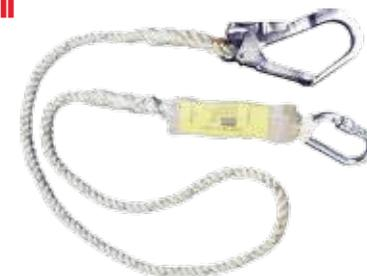
**ПЯ 040****Строп ТИТАН С3****РАЗРЫВНАЯ НАГРУЗКА:** 15000 Н**ДЛИНА:** 2,0 м**КОМПЛЕКТАЦИЯ:** страховочный строп из полиамидного каната Ø12 мм. На одном конце – крюк-карабин с самозакрывающимся замком (раскрытие – 63 мм), на другом конце стропа – карабин с винтовым замком СиЭс-20**ПРИМЕНЕНИЕ:** для работ на высоте в комплекте со страховочными привязями.
