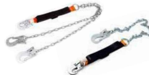
Строп из металлической цепи  $\varnothing 6$  мм с амортизатором используется как отдельная соединительная деталь, узел или компонент в системе с привязями и с анкерной точкой. Наличие амортизатора позволяет компенсировать травмоопасные динамические нагрузки на работающего при падении с высоты.
