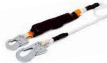
Строп из полиамидного каната  $\varnothing 13$  мм с амортизатором используется как отдельная соединительная деталь, узел или компонент в системе с привязями и с анкерной точкой. Наличие амортизатора позволяет компенсировать травмоопасные динамические нагрузки на работающего при падении с высоты.
