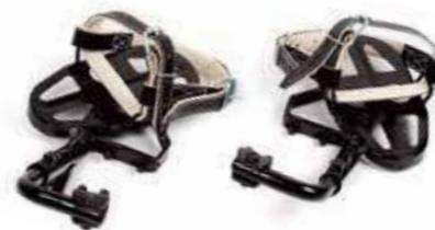
Предназначены для перемещения по железобетонным опорам трапецеидального сечения воздушных линий электропередачи типа СВ110-1а, СВ95-1а (2а), ГВ105-5. Регулировка раствора лаза осуществляется с помощью выдвижных труб, которые фиксируются двумя болтами с гайками и шайбами.
