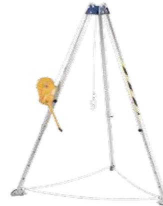
Переносное анкерное устройство трипод «СКАЛА» с интегрированной лебедкой предназначено для подъема, спуска и удержания пользователей, занятых при проведении работ в канализационных колодцах, бассейнах, шахтах и других замкнутых пространствах. Предназначено для закрепления средств безопасности (например, СИЗ втягивающего типа), для страховки от падения при подъеме и спуске людей.
