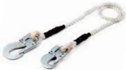
Строп из полиамидного каната  $\varnothing 13$  мм с двумя карабинами используется как отдельная соединительная деталь, узел или компонент в системе с привязями и с анкерной точкой. Строп оснащен с обеих сторон двумя карабинами для удобной работы и присоединения к элементу крепления привязи и к анкерной точке.
