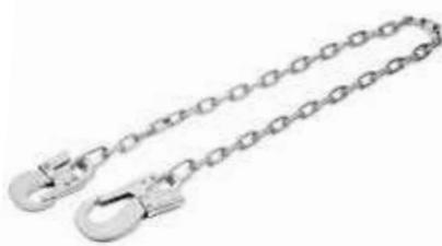
Строп из металлической цепи  $\varnothing 6$  мм с двумя карабинами используется как отдельная соединительная деталь, узел или компонент в системе с привязями и с анкерной точкой. Строп оснащен с обеих сторон двумя карабинами для удобной работы и присоединения к элементу крепления привязи и к анкерной точке. Может применяться для работ, связанных с огнем.
